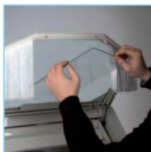
Sfilare con attenzione il vetro (vedi figura) e sostituirlo o pulirlo. Procedere di seguito con ordine inverso per riassemblare il tutto.
