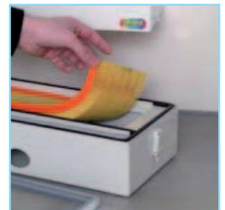
**3-** Togliere il filtro come da figura e pulirlo o sostituirlo. Procedere con ordine inverso per ri-assemblare.
