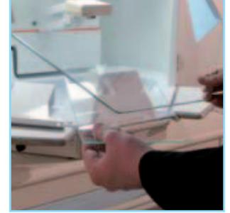
Per la sostituzione o pulizia del vetro frontale di protezione, sfilare il supporto reggi-vetro (come figura a Sx). Fare molta attenzione nel tenere il vetro con la mano Dx perchè potrebbe cadere in assenza dell'adeguato supporto; poi sfilare il vetro (come figura Dx). Per riassemblare, procedere con ordine inverso.
