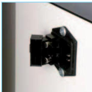
Nella presa di corrente del mini-box sono presenti due fusibili. In caso di non corretta accensione verificare il loro stato di efficienza e se necessario sostituirli.
